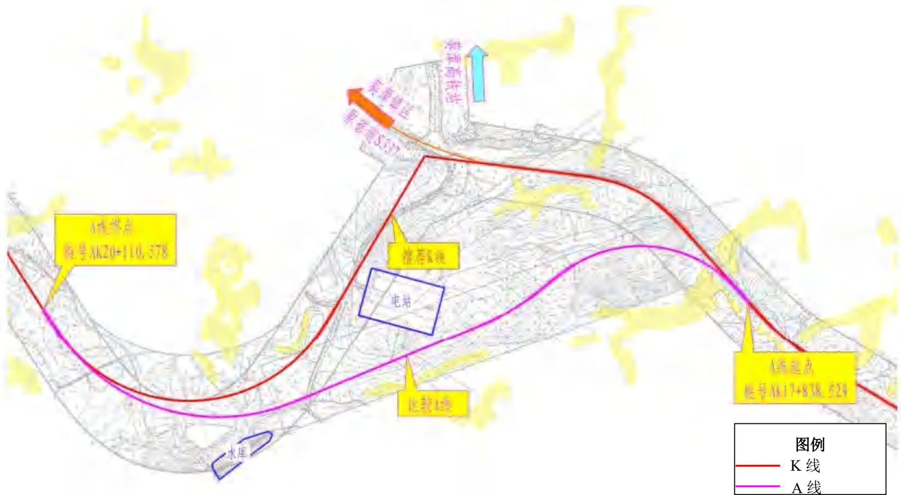
图 2.3.2-1 K 线与 A 线平面布置对比图
