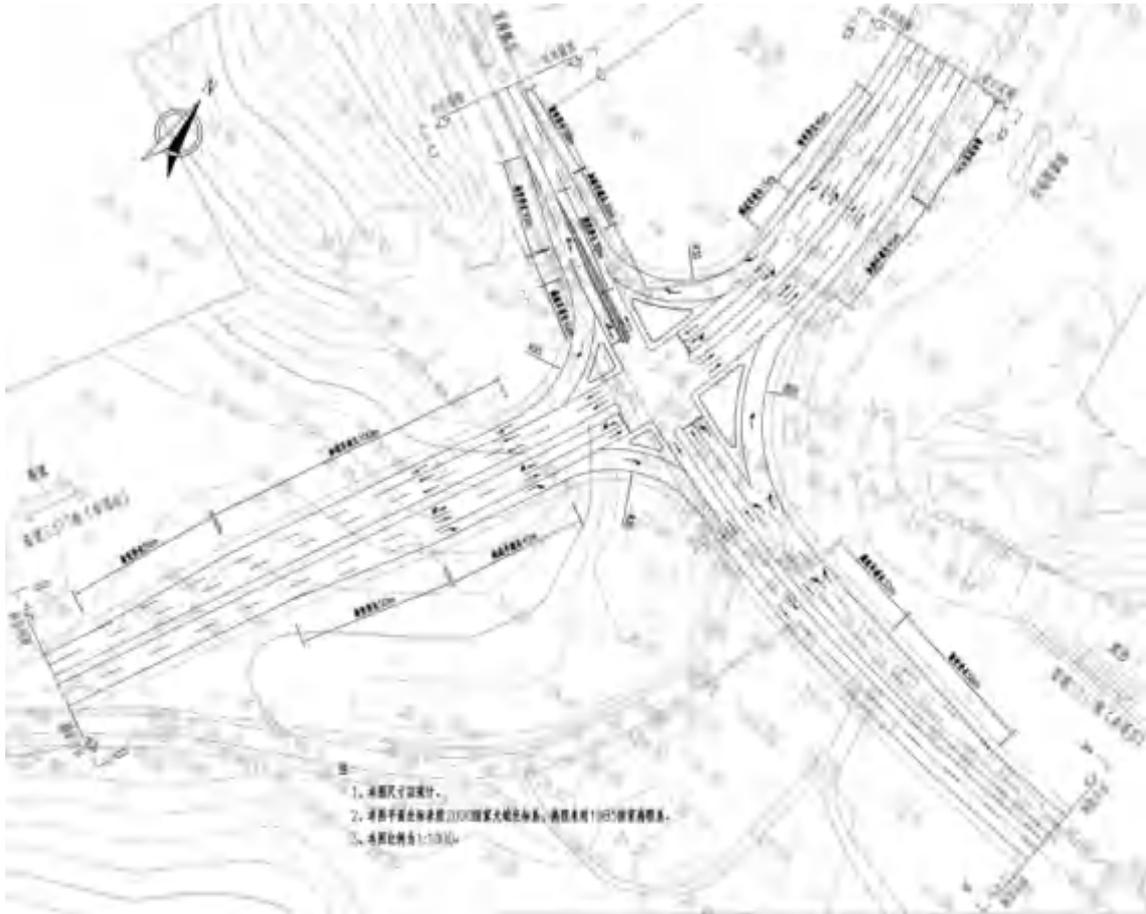
图 2.4.5-8 葵潭高铁站连接线平面交叉布置图
