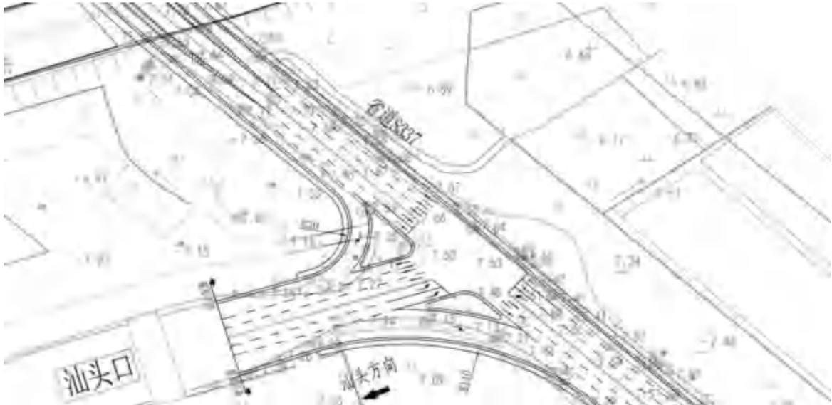
图 2.4.5-3 深汕高速出入口连接线平面交叉布置图
