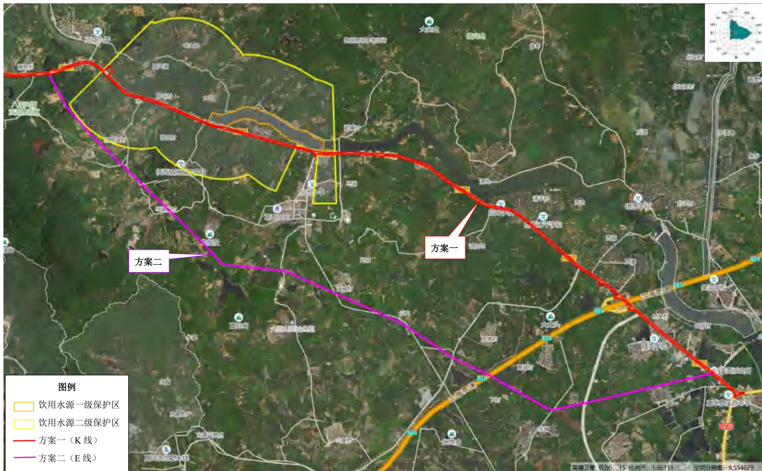
图 6.2.1-1 方案路线比选图 (针对饮用水源保护区)
