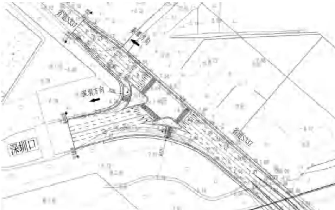
图 2.4.5-4 深汕高速出入口连接线平面交叉布置图
